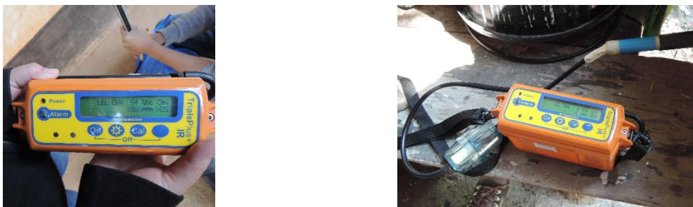
ภาพแสดงเครื่องวัดปริมาณก๊าซ (Gas Analyzer) และวิธีการวัดไปโอก๊าซ
